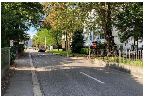
Abbildung 23: St.-Georgen-Strasse, Höhe Sulzbergstr. Die Ausfahrt Sulzbergstrasse (rechts) ist durch den Metallzaun und durch die Bepflanzung kaum wahrnehmbar. Für ausfahrende Fahrzeuge ist die Sicht auf Strasse und Trottoir eingeschränkt.
