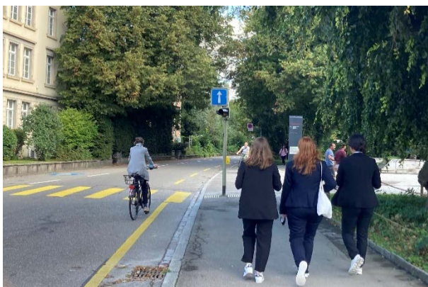
Abbildung 7: Museumstrasse, östlich Merkurstrasse Richtung Stadtpark wird die Museumsstrasse stark vom Fussgängerlängsverkehr frequentiert. Zudem befinden sich hier mehrere Grundstücks- und Gebäudezugänge in Fahrtrichtung links. Ein Trottoir als Fussgängerschutz oder als Warteraum für das Queren der Strasse ist nicht vorhanden. Der beginnende Velostreifen ist zu schmal.
