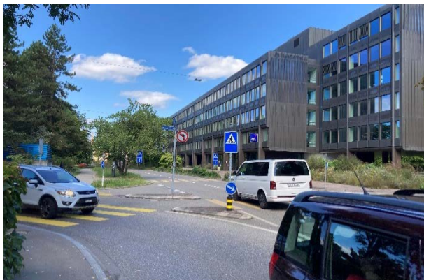
Abbildung 19: General-Guisan-, Höhe Museumstrasse Hier befinden sich zwei FGS über 2 Fahrstreifen derselben Richtung. Diese sind mit dem FGS über den fahrdynamischen Rechtsabbieger (links im Bild) Teil eines Schulwegs. Im Schulwegplan sind sie für Kinder als «Übergang nicht empfohlen» eingestuft.
