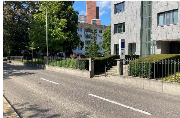
Abbildung 22: St.-Georgen-Strasse, Höhe Liebestrasse Typischer Grundstücksausgang an der verkehrsorientierten Sankt-Georgen-Strasse, welcher direkt auf die HVS führt. Eine Wartefläche auf Seite Strasse, um den Verkehr ausreichend beobachten zu können, existiert nicht.
